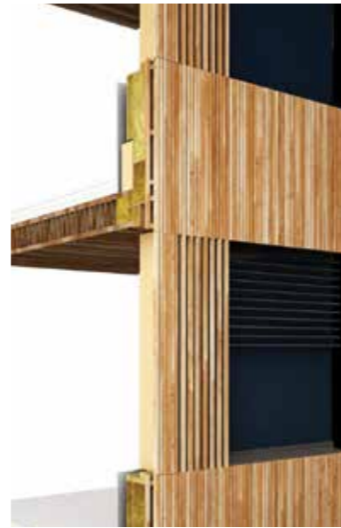
↑ Detailaufnahme eines Knotenpunktes des Holzskelettes
